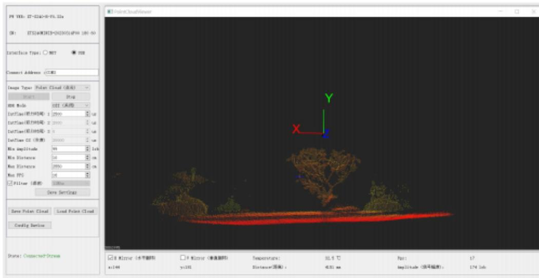
3) 测试结果：太阳光干扰被过滤，可获得近、远处植物较好点云效果并得到距离信息
